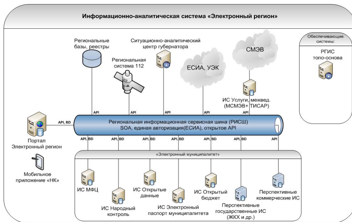
Рисунок 2. Архитектура информационно-аналитической системы «Электронный регион – Ростовская область»
